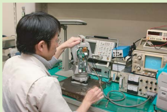
オシロスコープを用いて厳密調整
